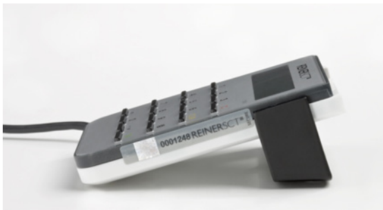
Sicherheitsversiegelung cyberJack secoder, rechte Seite
