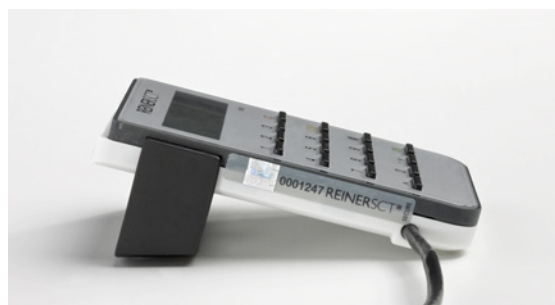
Sicherheitsversiegelung cyberJack secoder, linke Seite
